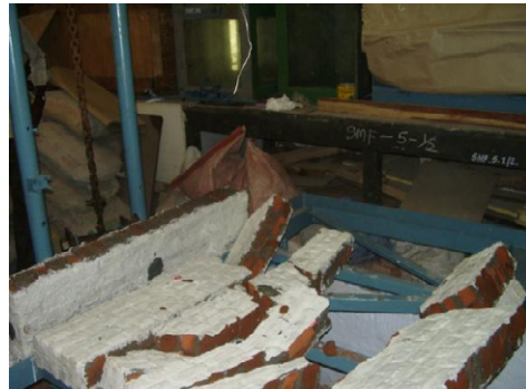
Figure 9a. Wall collapsed
